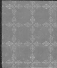
マイクロプリズム式反射素材
