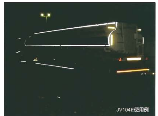
大型後部反射器、JV104E、AP1000車両マーキング使用例
