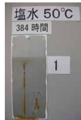
一般エポキシ系塗膜 塩水没水
