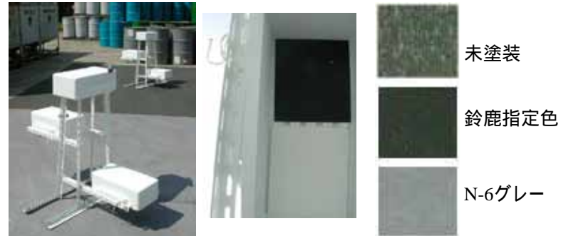
輻射熱測定装置(ボックス内に塗板取付)
