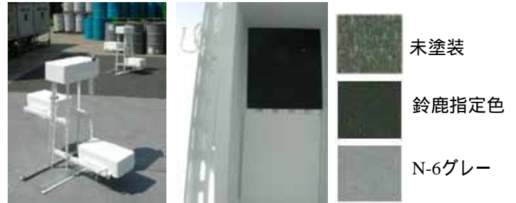
輻射熱測定装置(ボックス内に塗板取付)
