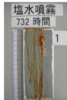
一般エポキシ系塗膜 塩水没水
